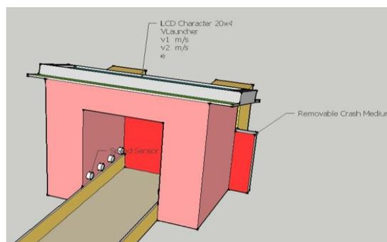
Fig. 4. Speed Sensor
